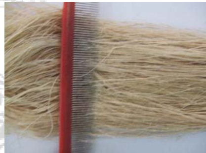
ภาพที่ 6 เส้นใยที่ผ่านจากเครื่องแยกเส้นใย และหวีสางเส้นใย
