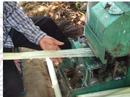
ภาพที่ 4 ลักษณะการนำกาบกล้วยเข้าเครื่องแยกเส้นใยกล้วย
