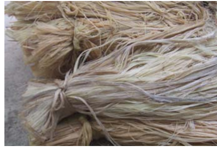
ภาพที่ 5 นำเส้นใยกล้วยที่ผ่านจากเครื่องแยกเส้นใย ไปทำการแยกเส้นใยกล้วยด้วยวิธีการแบบต่างๆ
