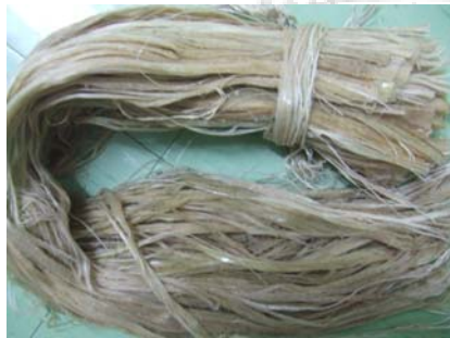
ภาพที่ 6 เส้นใยที่ผ่านจากเครื่องแยกเส้นใย และหวีสางเส้นใย
