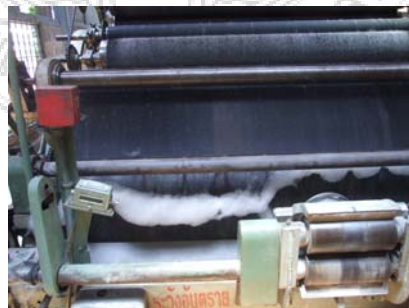
เส้นใยที่ผ่านลูกกลิ้งจะออกมาด้านหลังเครื่องและถูกดึงออกมาในรูปแบบของ SLIVER
