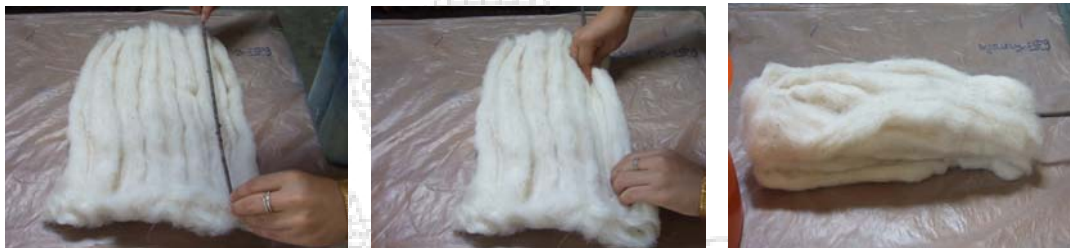
ภาพที่ 3.5: แสดงทิศทางการวาง SLIVER ตามยาว
