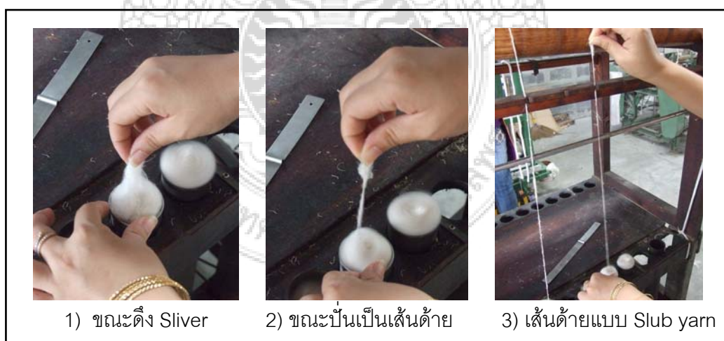
ภาพที่ 4.5: แสดงลักษณะการปั่นเส้นด้ายพิเศษแบบ SLUB YARN โดยมีทิศทางการวาง SLIVER ตามยาวในกระบอบบรรจุเส้นใยของเครื่อง GAREBO
