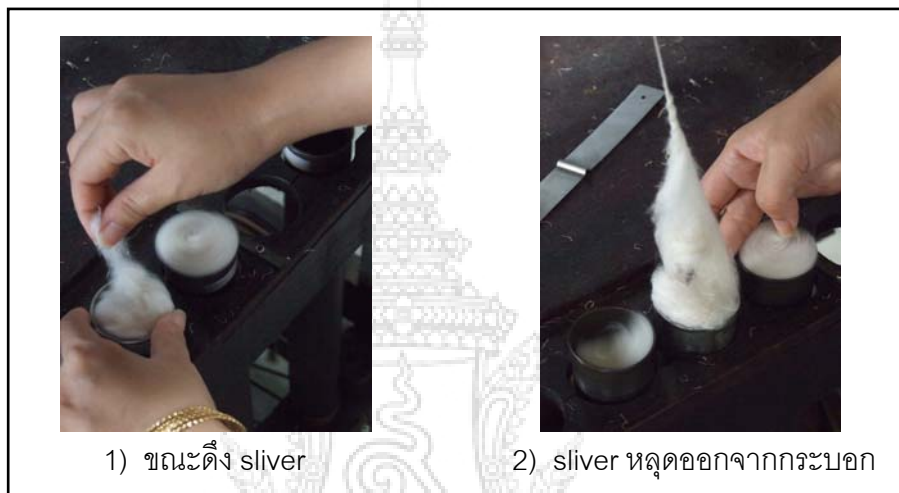
ภาพที่ 4.6: แสดงลักษณะการปั่นเส้นด้ายพิเศษแบบ SLUB YARN โดยมีทิศทางการวาง SLIVER ทำมุม 45 องศา ในกระบอบรรจุเส้นใยของเครื่อง GAREBO
