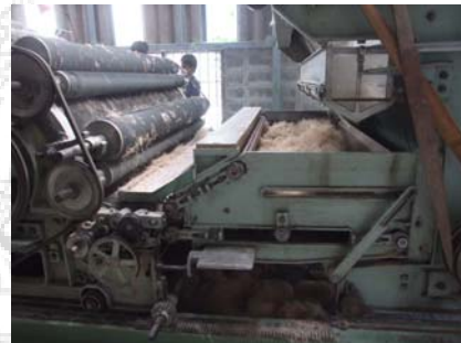
ภาพแสดงส่วนเก็บเส้นใยที่ผสมแล้วก่อน
