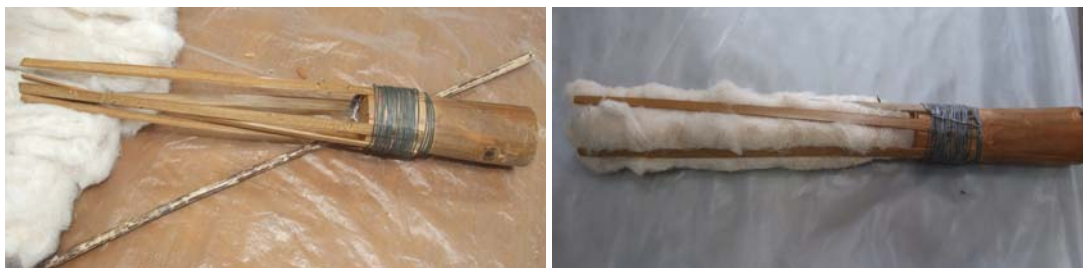
ภาพที่ 3.3: แสดงลักษณะอุปกรณ์ที่ใช้บรรจุเส้นใยเข้าสู่กระบอ
