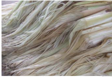
ภาพที่ 5 นำเส้นใยกล้วยที่ผ่านจากเครื่องแยกเส้นใย ไปทำการแยกเส้นใยกล้วยด้วยวิธีการแบบต่างๆ
