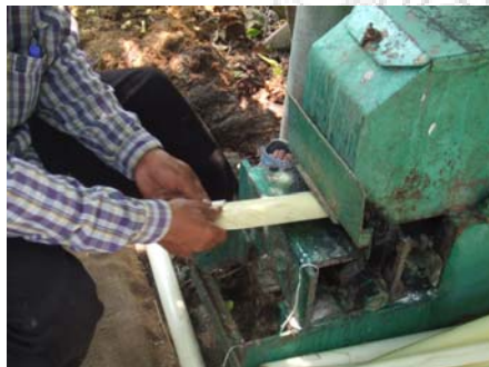
ภาพที่ 4 ลักษณะการนำกาบกล้วยเข้าเครื่องแยกเส้นใยกล้วย
