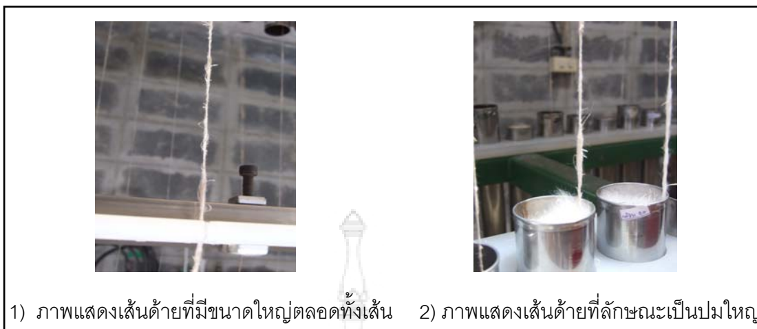
ภาพที่ 4.4: แสดงลักษณะการปั่นเส้นด้ายพิเศษแบบ SLUB YARN โดยมีทิศทางการวาง SLIVER ตามขวางในกระบอบบรรจุเส้นใยของเครื่อง GAREBO
