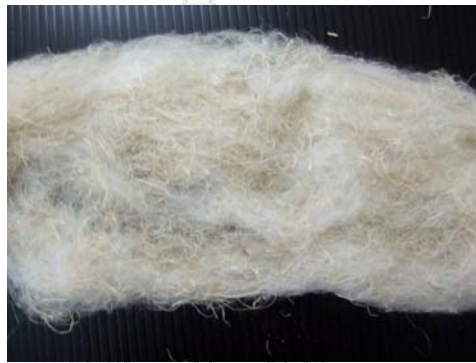
ภาพที่ 4.3: แสดงลักษณะของเส้น SLIVER ที่มีอัตราส่วน 60 : 40
