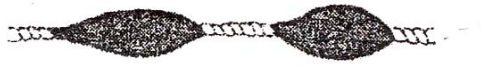
ภาพที่ 2.13: แสดงลักษณะเส้นด้าย Slub Yarn
