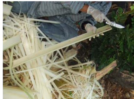
ภาพที่ 3 ลักษณะกาบกล้วยที่ตัดขนาดกว้างประมาณ 3 – 4 นิ้ว
