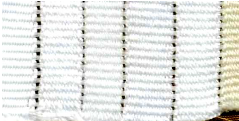
ภาพที่ 2.9 ผ้าหลายเส้นใย (multifibre)
