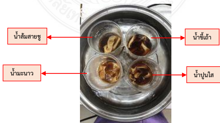
ภาพที่ 4.6 การทดลองย้อมโดยสารช่วยติดขณะกระบวนการย้อมผ้าฝ้าย
