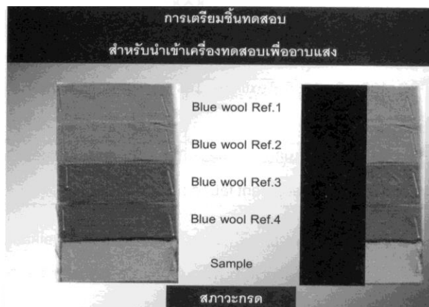
ภาพที่ 2.10 การทดสอบความคงทนของสีต่อแสง
