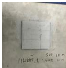
รูปที่ 2 แผ่นด้านหน้า 10 มิลลิเมตร SKD11 แผ่นด้านหลัง 10 มิลลิเมตร SUS304 [1], [13]
