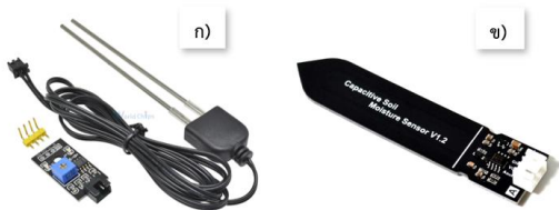
รูปที่ 3 ก) เซนเซอร์วัดความชื้นในดินชนิดต้านทาน ข) เซนเซอร์วัดความชื้นในดินชนิดเก็บประจุ
