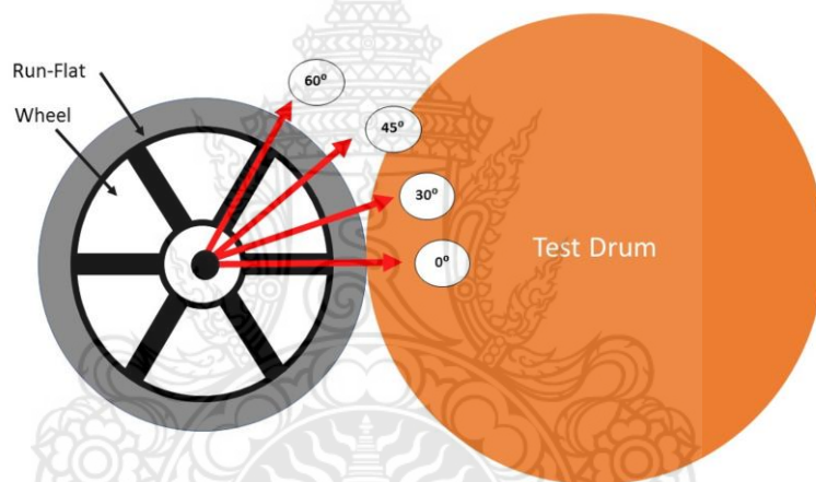
รูปที่ 3.14 โครงสร้างระบบทดสอบหาค่าความเครียดด้วยเครื่องทดสอบการห้ามล้อ
