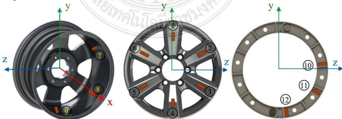
รูปที่ 4.4 โมเดลสามมิติและตัวอย่างผลการวิเคราะห์ความเค้นด้วยระเบียบวิธีไฟไนต์เอลิเมนต์
