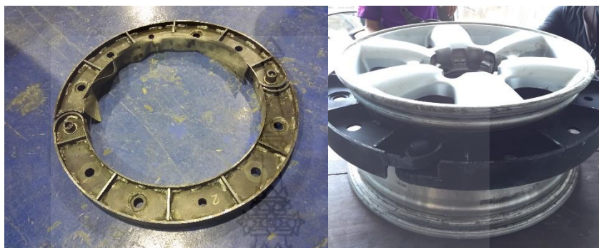
รูปที่ 1.3 ล้อรันแฟลทโลหะแบบเดิมสวมเข้ากับกระทะล้อ [1]
