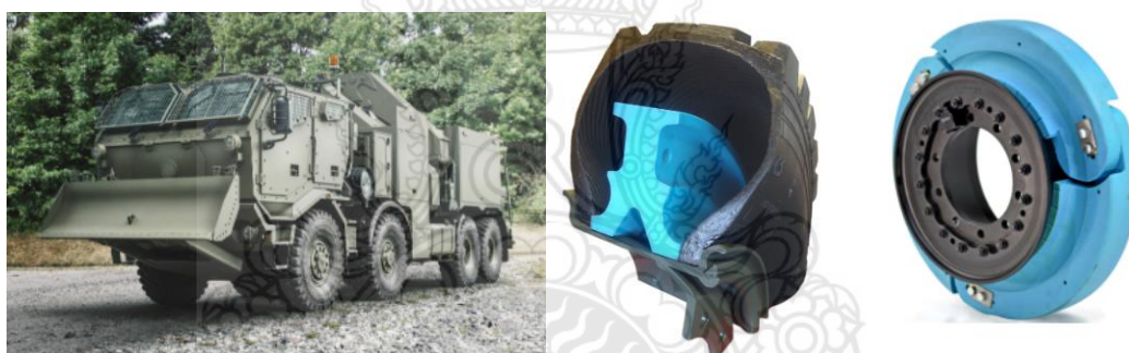
รูปที่ 1.4 ล้อรันแฟลทสำหรับยานเกราะทางทหาร [2]
