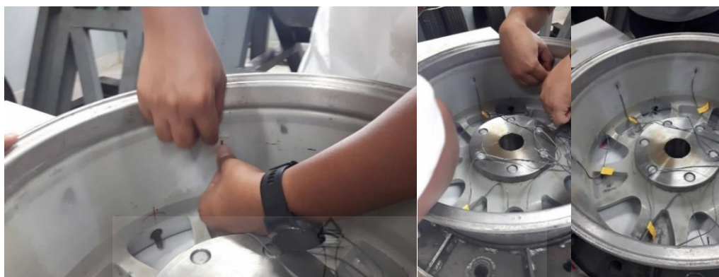
รูปที่ 4.2 การติดตั้ง Strain gage เข้ากับกระทะล้อและล้อรันแพลท
