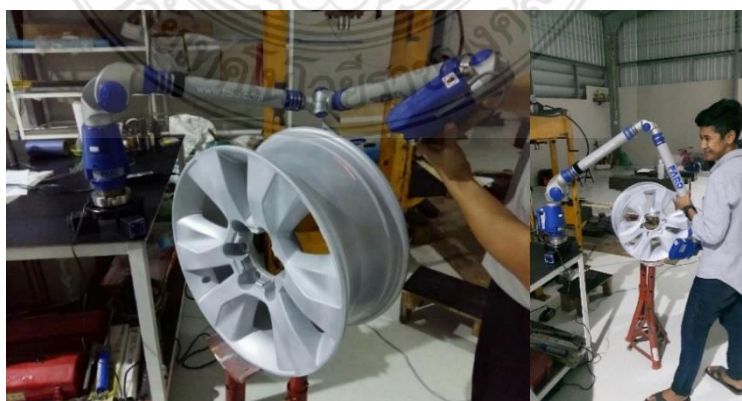
รูปที่ 4.12 สแกนล้ออัลลอยด้วยเครื่อง 3d scan ของ FARO P06-05
