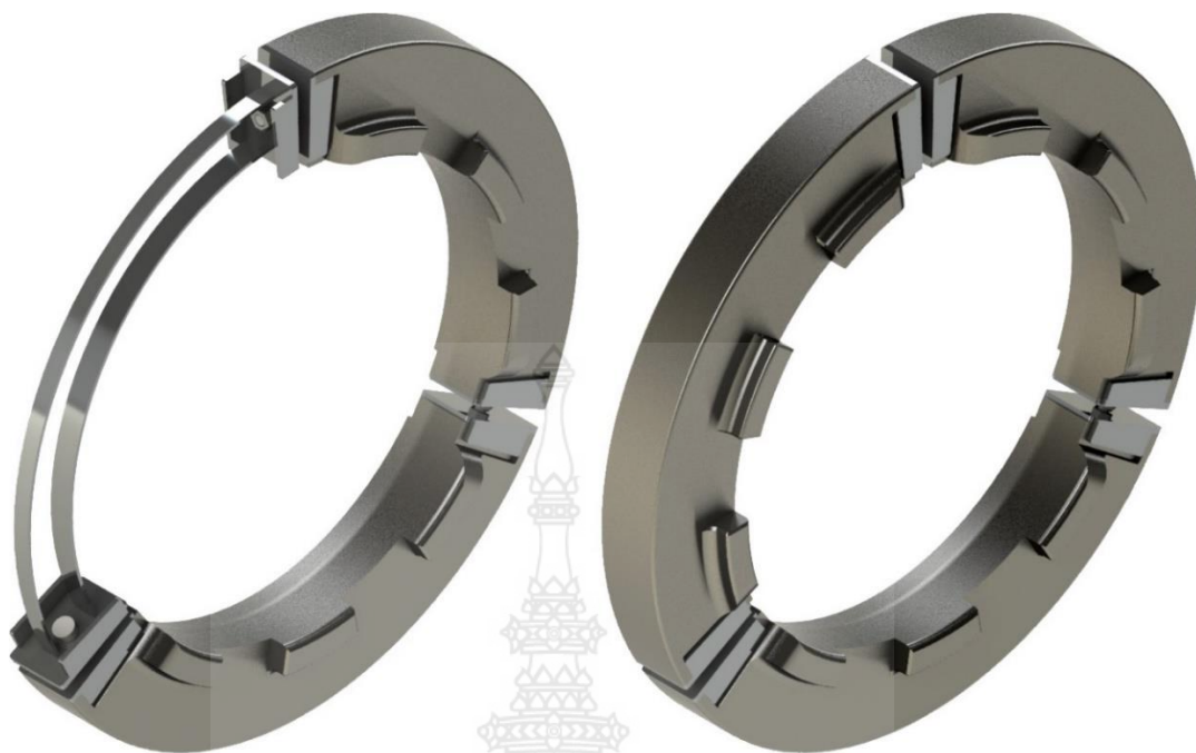
รูปที่ 4.19 โมเดลวงล้อรันแพลทรูปทรงใหม่หลังจากการปรับปรุงข้อด้อยที่ได้จากการทดสอบ และการตัดแสดงโครงสร้างภายใน
