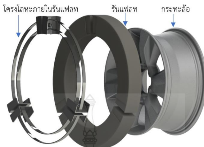
รูปที่ 4.21 ภาพระเบิดชิ้นส่วนแสดงส่วนประกอบลื้อรีนแพลท
