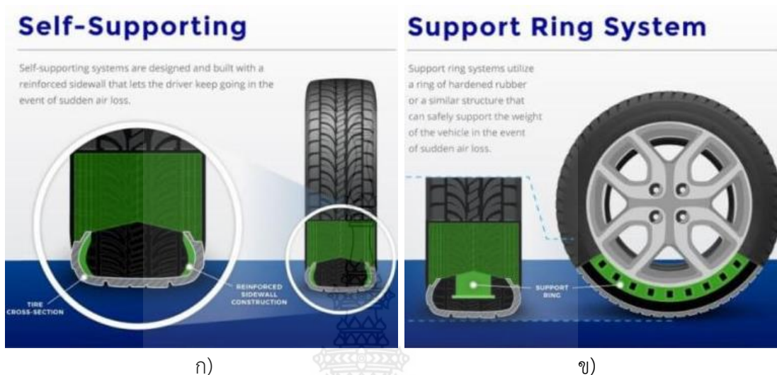
รูปที่ 2.4 ล้อยางรันแฟลท ก) Self-Supporting Tire และ ข) Supporting Ring System [14]
