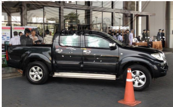
รูปที่ 1.1 รถยนต์บรรทุกทุกประเภทขนาดเล็กติดเกราะที่พัฒนาโดยบริษัท เจเอส แอนด์ มิวเสส จำกัด
