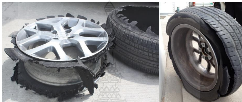
รูปที่ 1.2 การเสียหายของยางรถยนต์ที่ผ่านการวิ่งโดยไม่มีลมยางและไม่มีล้อรันแฟลท
