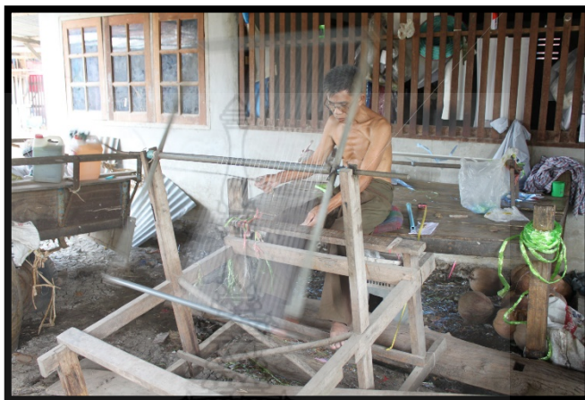
ภาพที่ ง4 การคั้นหมี่ ด้วยเครื่องคั้นหมี่แบบโบราณ คั้นหมี่จำนวน 35 แถว คือลายมัดหมี่ 35 ลำ ที่มา : กรชนก บุญทร (2564)
