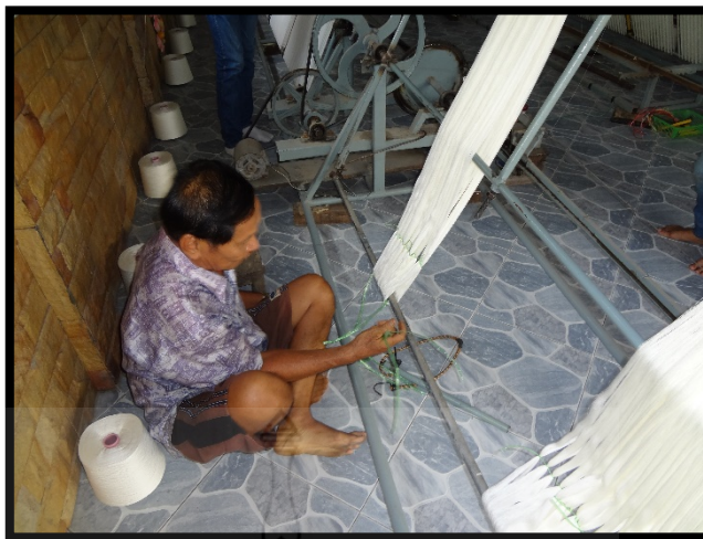
ภาพที่ ง6 ใช้เชือกฟางมัดเพื่อไม่ให้ไหมแตกออกจากกัน แล้วถอดออกจากเครื่องคันหมี จากนั้นนำไปใส่โองหมี
