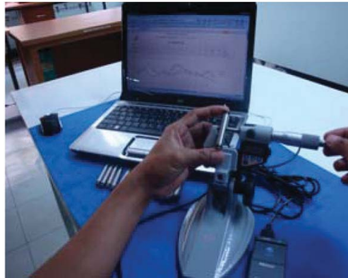
รูปที่ 2 การตรวจสอบคุณภาพชิ้นส่วนด้านขนาด
