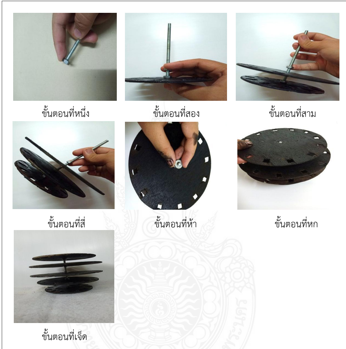
ภาพที่ 3.14 การประกอบโครงสร้างพานพุ่มทรงบาตร
