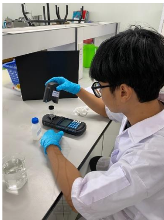
ภาพ 3.19 ขั้นตอนการบรรจุตัวอย่างและการอ่านค่าสีด้วยเครื่องวิเคราะห์สี
