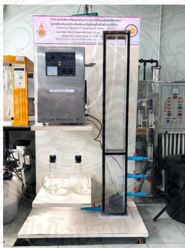
ภาพ 3.21 ชุดจำลองระบบบำบัดน้ำเสีย
