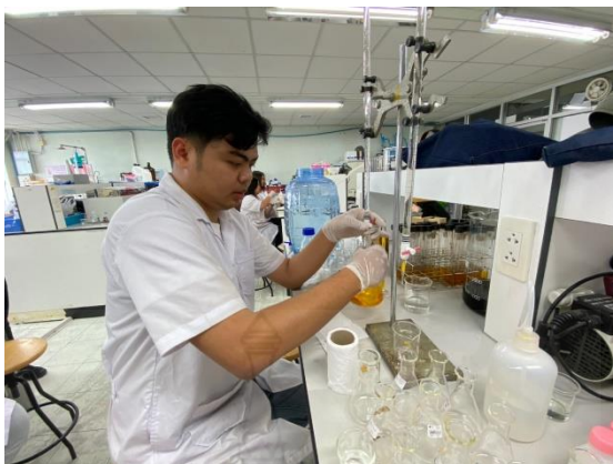
ภาพ 3.14 ขั้นตอนการไทเทรตตัวอย่างด้วยสารละลาย FAS ความเข้มข้น 0.25 N
