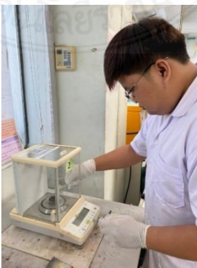
ภาพ 3.10 ขั้นตอนการชั่งน้ำหนักกระดาศกรอง
