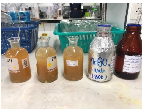
ภาพ 3.10 เติมสารละลายแมงกานีสซัลเฟต 1 มิลลิลิตรและเติมสารละลายอัลคาไลไฮโดรเจนเพอร์ออกไซด์ 2 ml ลงในขวด BOD
