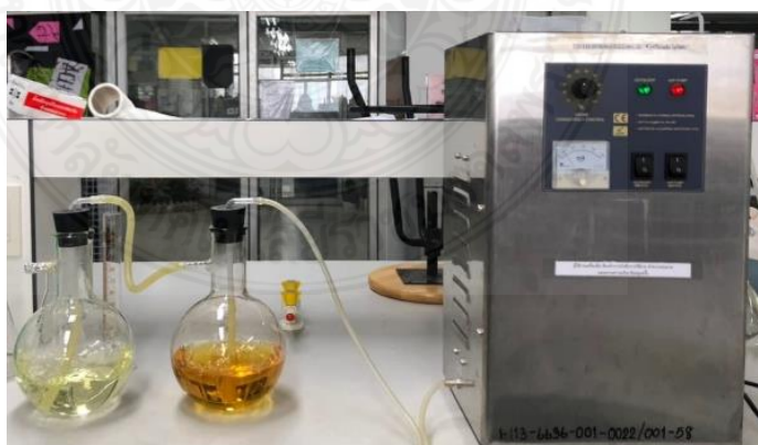
ภาพ 3.4 การทดลองหาปริมาณโอโซน (Ozone) ที่ผลิตจากเครื่องผลิตโอโซน
