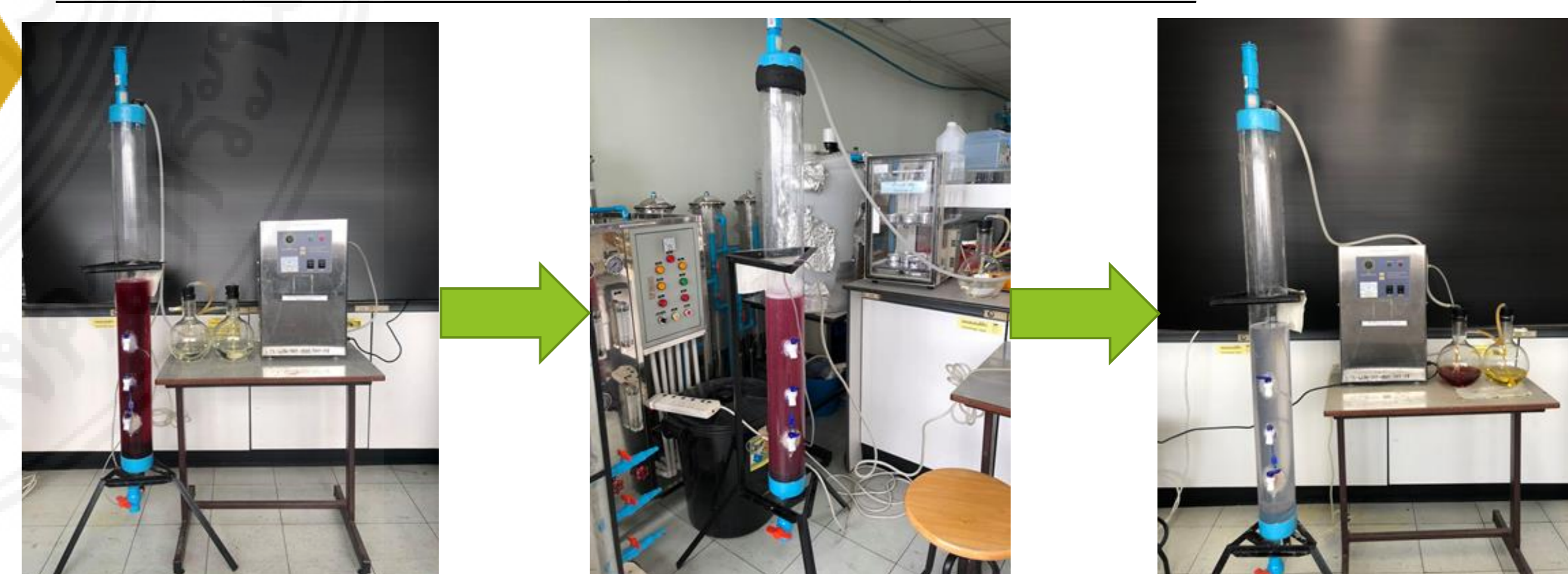
ภาพ 1 ก่อนการบำบัด ภาพ 2 หลังเป่าโอโซนได้ระยะหนึ่ง ภาพ 3 หลังเป่าโอโซนครบ 2 ชม.
