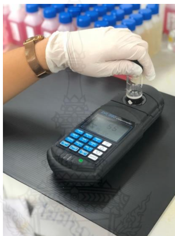
ภาพ 3.8 ขั้นตอนการวิเคราะห์สี ด้วยเครื่อง Hach DR/890 Colorimeter
