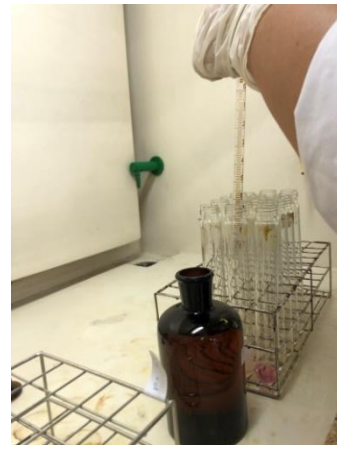
(ข) เติมกรดซัลฟูริกและเติมเมอคิวรีซัลเฟต
