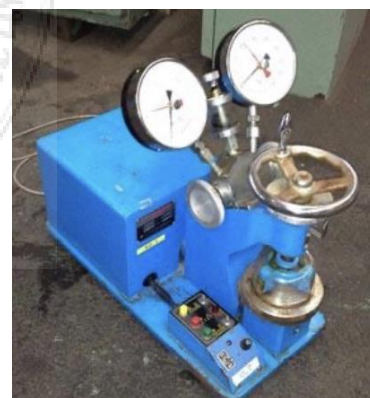
ภาพที่ 3.13 เครื่องทดสอบความแข็งแรงต่อแรงดันทะลุ
