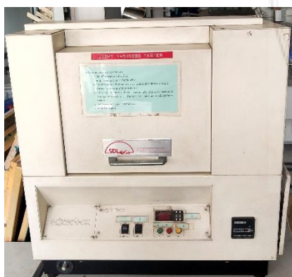
ภาพที่ 3.11 เครื่องทดสอบความคงทนของสีต่อแสงแดดเทียม
