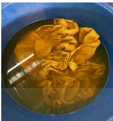
ภาพ 3.10 แสดงภาพแช่สารช่วยติดสีจากสารเคมี สารส้ม
