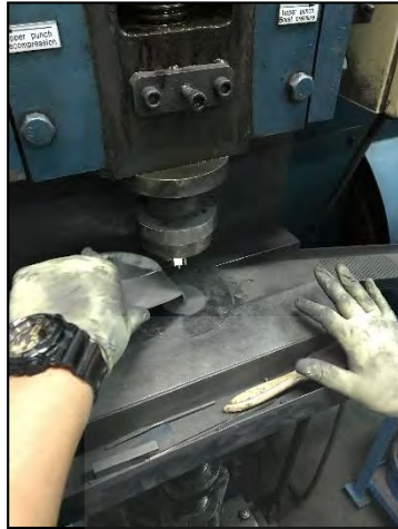
ภาพ 3.11 การเติมผงทั้งสแตนคาร์ไบด์เข้าเป้ากลางแม่พิมพ์
