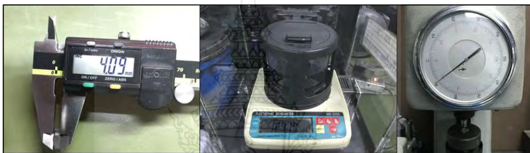
ภาพ 3.18 การตรวจสอบคุณภาพแผ่นมิดทั้งสแตนคาร์ไบด์ที่ผ่านกระบวนการอบพริก
