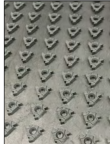
ภาพ 3.12 แผ่นมีดทั้งสแตนคาร์ไบด์ที่ผ่านกระบวนการอัดขึ้นรูป
