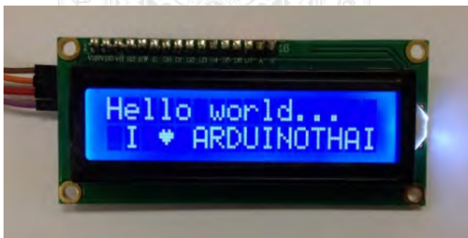
ภาพ 3.7 โมดูล Port IIC/I2C/TWI/SPI Interface Module for 1602 LCD Display
