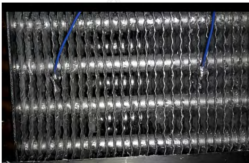
ภาพ 4.16 ลักษณะหยดน้ำแข็งจับตัวเป็นก้อนเล็กน้อยตามครีบของเครื่องระเหย
