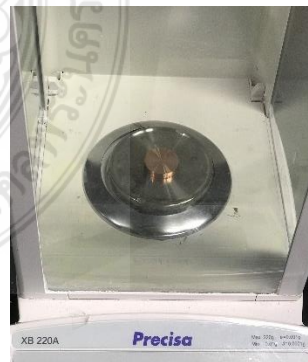
รูปที่ 5 นำชิ้นงานไปทดสอบโดยวางตำแหน่งตรงกลางของถังจำลองเป็นเวลา 1 ชั่วโมง
