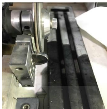
รูปที่ 3.6 การ Cross section โดยเครื่องตัดชิ้นงานรุ่น Isomet 5000 ของบริษัท BUEHLER
