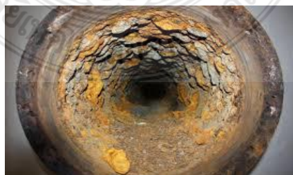
รูปที่ 2.9 การกัดกร่อนแบบ Erosion Corrosion [28]
