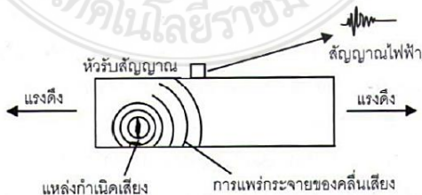
รูปที่ 2.22 ตัวอย่างระบบการทดสอบด้วยอะคูสติกอิมิชัน [6]
