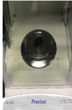
รูปที่ 4 วัดขนาดชิ้นงาน จากนั้นนำชิ้นงานไปขัดเปิดผิวชิ้นงาน แล้วชั่งน้ำหนัก
