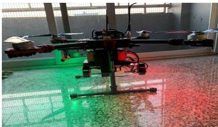
ภาพ 3.5 การประกอบชุดตรวจวัดก๊าซเข้ากับอากาศยานไร้คนขับ
