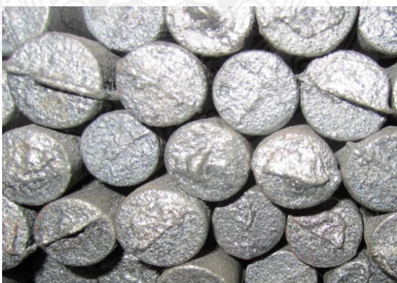
ภาพที่ 2.15 แสดงรูปลักษณะของเหล็กหล่อ แหล่งที่มา : บริษัท ไชยเจริญเทคนิค จำกัด, (2541)
