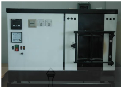
รูปที่ 3.4 เตาไฟฟ้าที่ใช้ในการหลอมแก้ว สามารถเผาได้อุณหภูมิสูงสุดถึง 1700 องศาเซลเซียส
