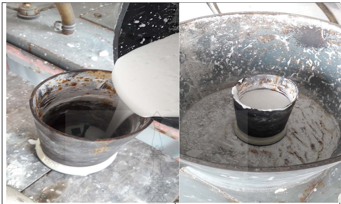
รูปที่ 3.9 แสดงการเทปูนลงในแบบพิมพ์
