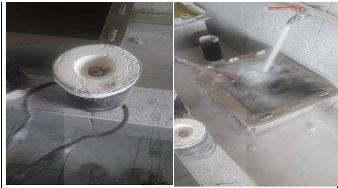
รูปที่ 3.12 การล้างกระบอกโลหะหลังการหล่อ
