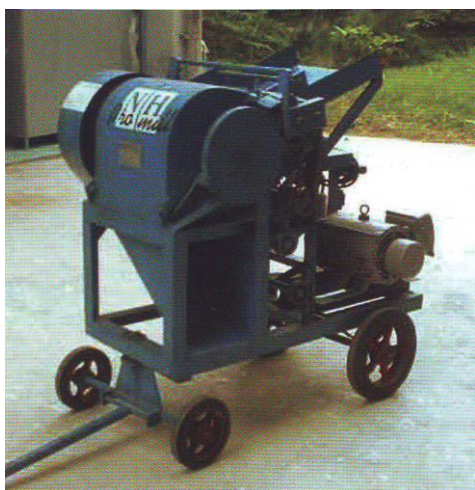
ภาพที่ 18 : เครื่องสับชิ้นไม้และวัสดุทางการเกษตร ที่มา : http://lighttrio.com/
