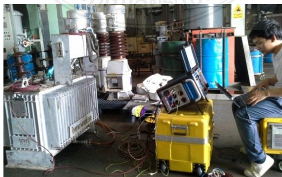
ภาพที่ 2.8 ทดสอบ Winding resistance หม้อแปลง Distribution
