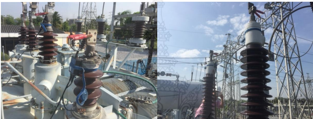
ภาพที่ 3.4 วิธีการเชื่อมต่อสายสัญญาณจากเครื่อง ทดสอบ FRA 5310 กับขั้วของหม้อแปลงที่ต้องการทดสอบ
