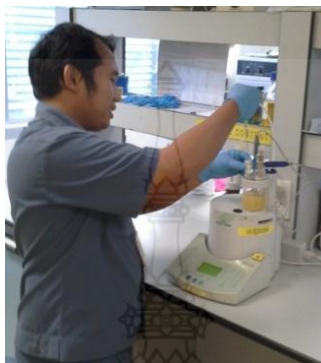
ภาพที่ 2.11 การฉีดตัวอย่างน้ำมันเข้าเครื่องทดสอบ moisture content
