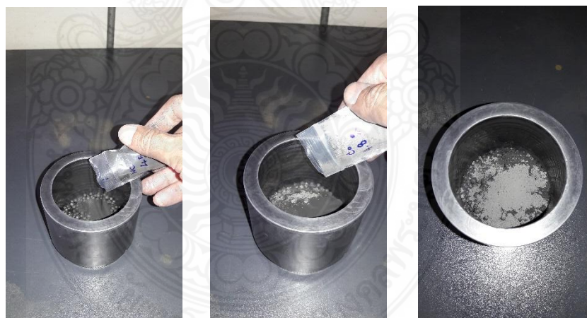
ภาพ 4.17 ผสมผงทังสเตนคาร์ไบด์รีไซเคิลและโคบอลต์
