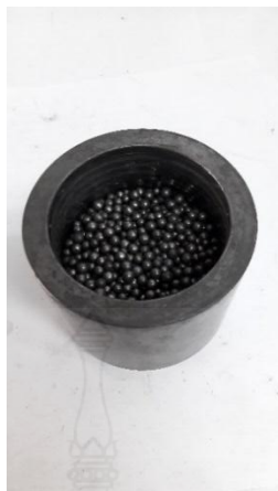
ภาพ 4.6 การใส่ผงทั้งสแตนคาร์ไบด์รีไซเคิลและลูกบดลงในหม้ออบ
