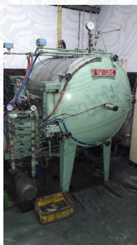
ภาพ 4.37 เตาอบสุญญากาศใช้ในการอบพูนิก
