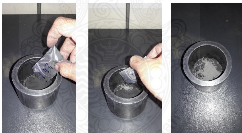
ภาพ 4.21 ผสมผงสังสแตนคาร์ไบด์รีไซเคิลและโคบอลต์
