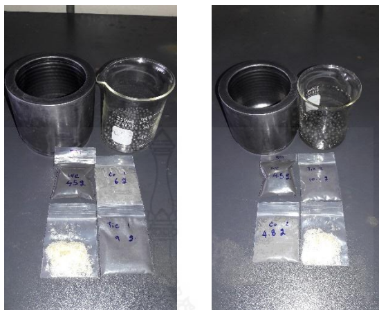
ภาพ 4.16 เตรียมวัตถุดิบในการผสมตาม Sample ที่ 1 และ 2 ปริมาณที่กำหนด
