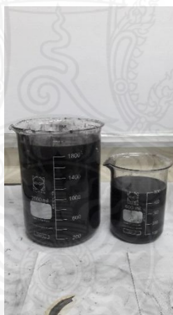
ภาพ 4.9 การรอให้ทังสเตนคาร์ไบด์ตกตะกอน
