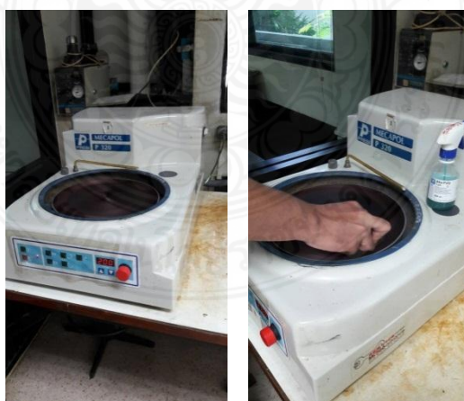
ภาพ 4.43 เครื่องขัดสำหรับเตรียมชิ้นงานทดสอบความแข็งเม็คมิด
