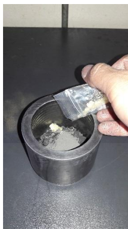
ภาพ 4.22 ผสมพาราฟินแวกซ์กับผงทั้งสแตนคาร์ไบด์รีไซเคิลและโคบอลต์
