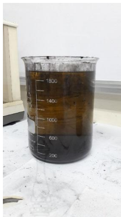
ภาพ 4.10 การตกตะกอนของผงทั้งสแตนคาร์ไบต์
