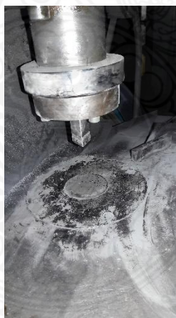
ภาพ 4.33 การใส่ผงเข้าในพิมพ์เม็ดมีดเตรียมอัดขึ้นรูป
