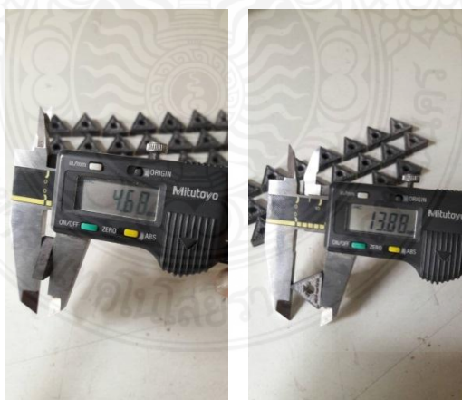
ภาพ 4.41 การวัดชิ้นงานเม็ดมีดหลังการอบผนึก
