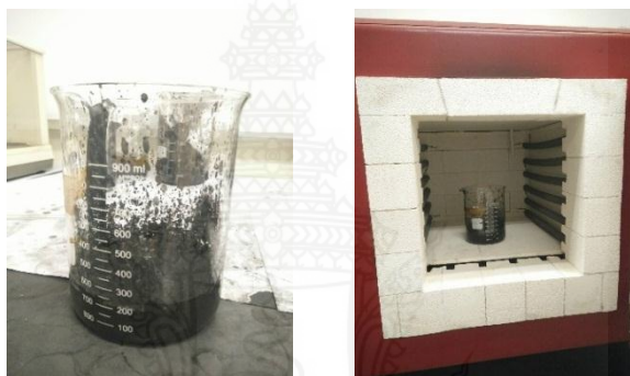
ภาพ 4.12 การเตรียมการอบแห้งผงทั้งสแตนคาร์ไบด์
