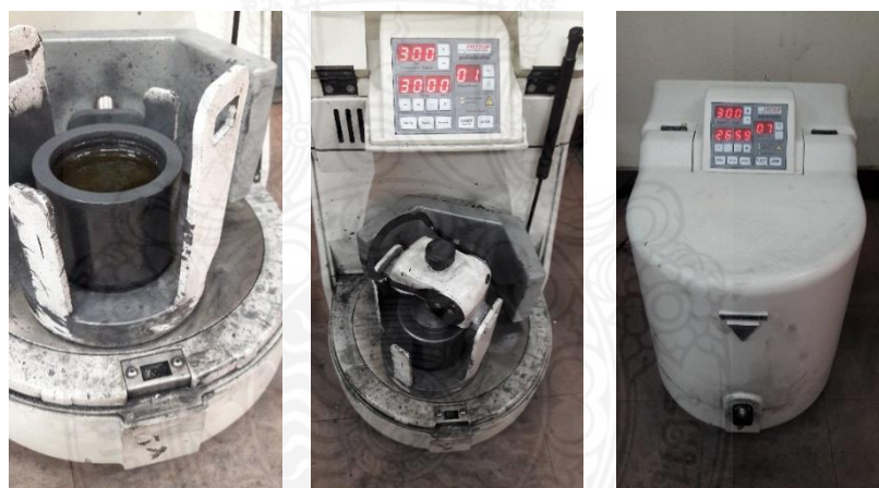
ภาพ 4.7 การใส่หม้ออบเข้าเครื่องเตรียมการบด
