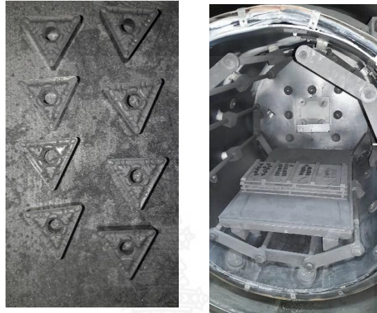
ภาพ 4.38 นำชั้นงาน green compact เข้าเตาอบสุญญากาศ
