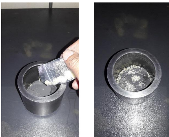
ภาพ 4.18 ผสมพาราฟินแวกซ์กับผงทั้งสแตนคาร์ไบด์รีไซเคิลและโคบอลต์
