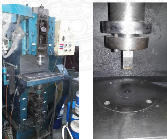
ภาพ 4.31 เครื่องอัดขึ้นรูปผงโลหะและแบบแม่พิมพ์
