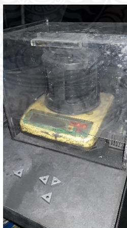
ภาพ 4.35 การวัดความหนาแน่น green compact หลังจากการอัดขึ้นรูป
