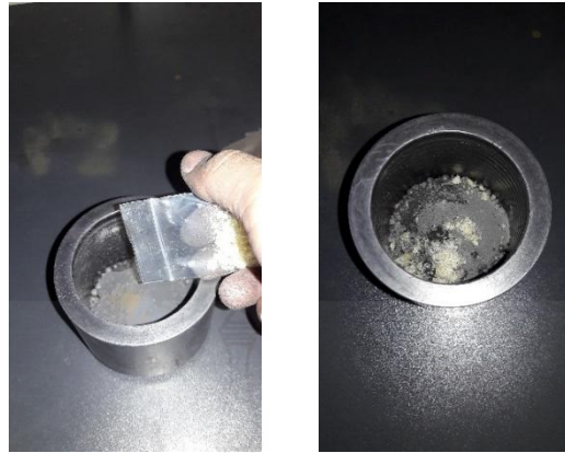
ภาพ 4.26 ผสมพาราฟินแวกซ์กับผงทั้งสแตนคาร์ไบด์รีไซเคิลและโคบอลต์
