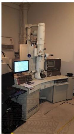
ภาพ 4.30 เครื่องวิเคราะห์กล้องจุลทรรศน์อิเล็กตรอนชนิดส่องผ่าน (Transmission Electron Microscope: TEM)
