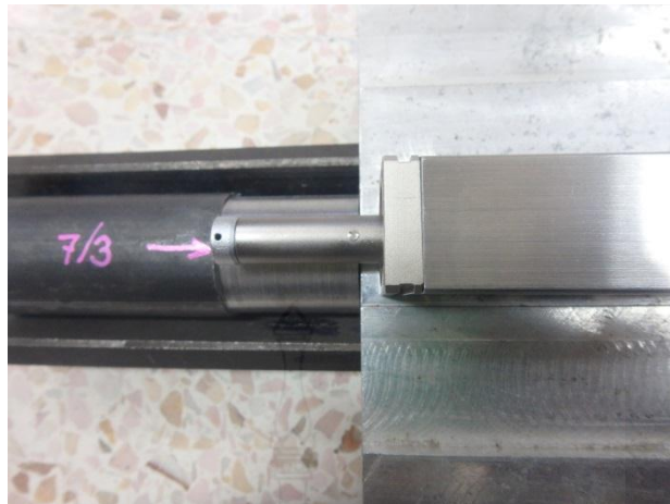
ภาพ 4.50 การทดสอบความเรียบผิว
