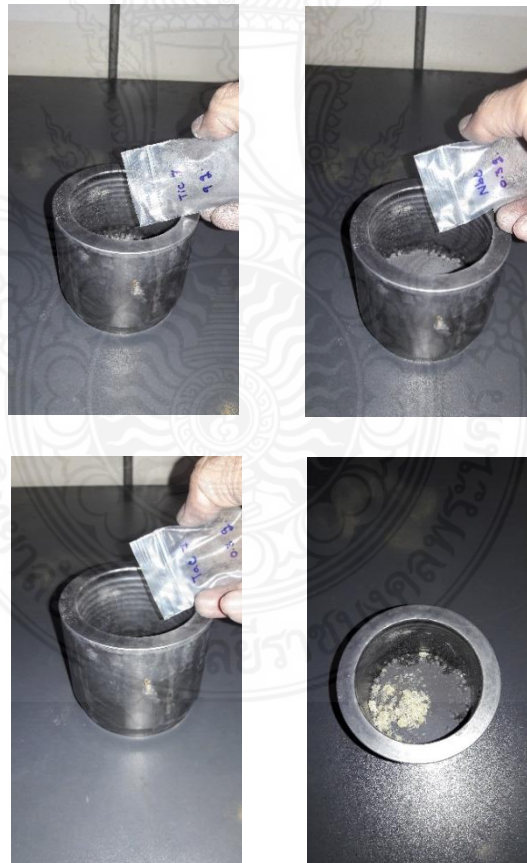
ภาพ 4.27 ใส่ผงไททาเนียมคาร์ไบด์กับไนโอเบียมคาร์ไบด์และแทนทาลัมคาร์ไบด์
