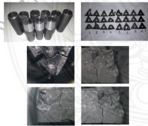
รูปที่ 3 ชิ้นงานและเม็ดยัดหลังการทดสอบ
