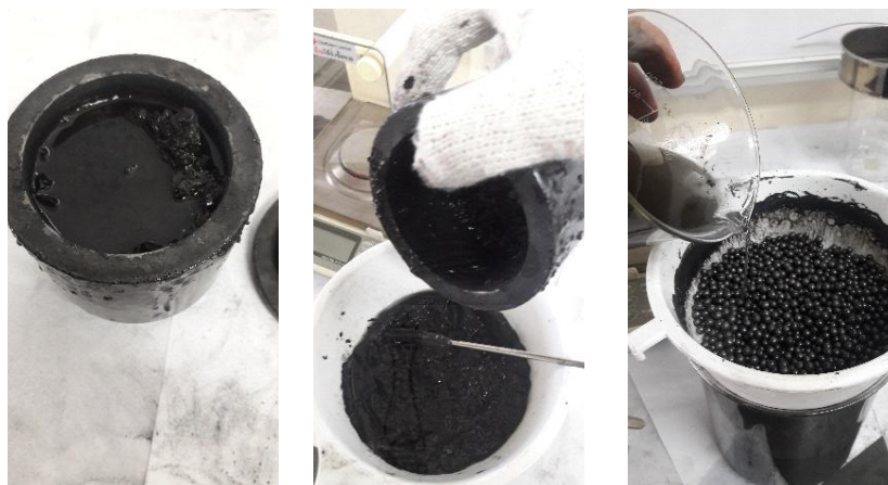
ภาพ 4.8 การเตรียมการคัดแยกผงทังสเตนคาร์ไบด์ออกจากลูกบด
