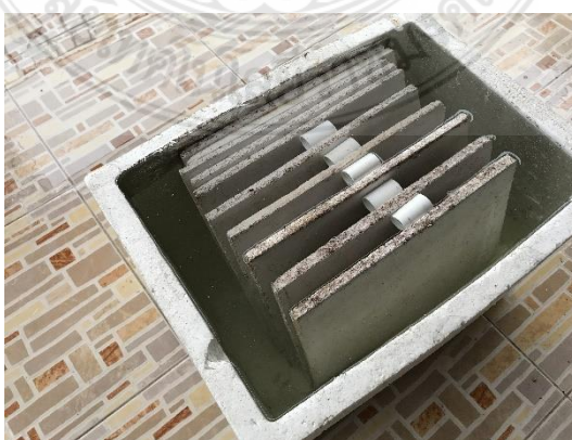
รูปที่ 3.17 การแช่แผ่นฝ้าเพดานชুমะพร้าวลงในน้ำเพื่อทดสอบการดูดซึมน้ำ
