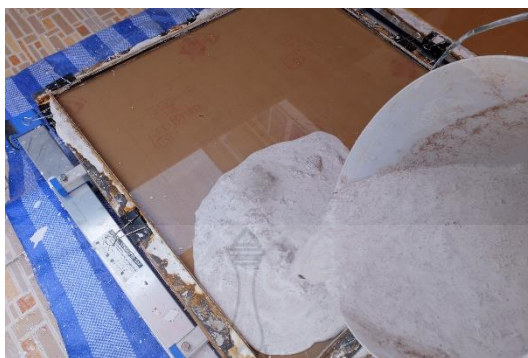
รูปที่ 3.10 การเทส่วนผสมผ้าเบตาในแบบหล่อ
