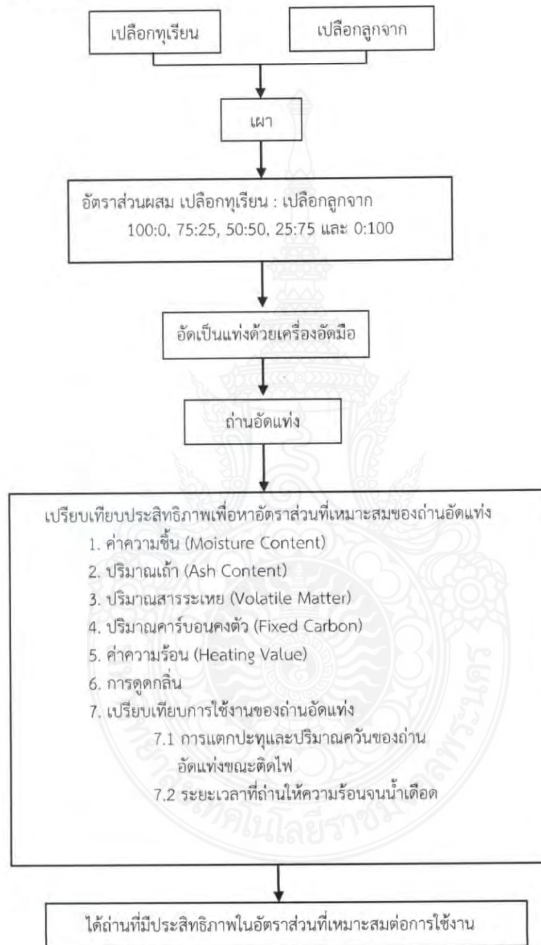
ภาพที่ 1-1 กระบวนการผลิตถ่านอัดแท่งจากวัสดุเหลือทิ้งทางการเกษตร โดยใช้เปลือกทุเรียนผสมเปลือกลูกจาก
