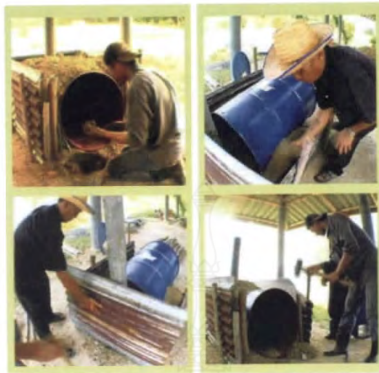
ภาพที่ 2-8 เต้าเผาถ่านขนาด 200 ลิตรแบบนอน
