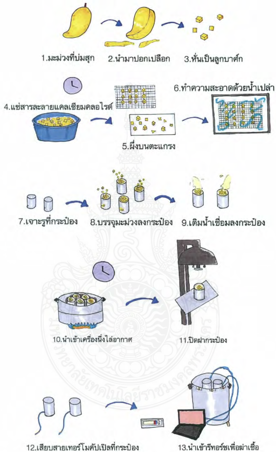
แผนภาพที่ 3.3 แสดงกระบวนการผลิตมะม่วงบรรจุกระป๋อง
