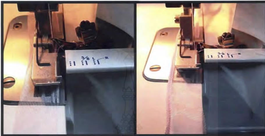
ภาพที่ 3.20 นำผ้าที่ตัดเสร็จไปพันริมกับเครื่องจักรพันริม
