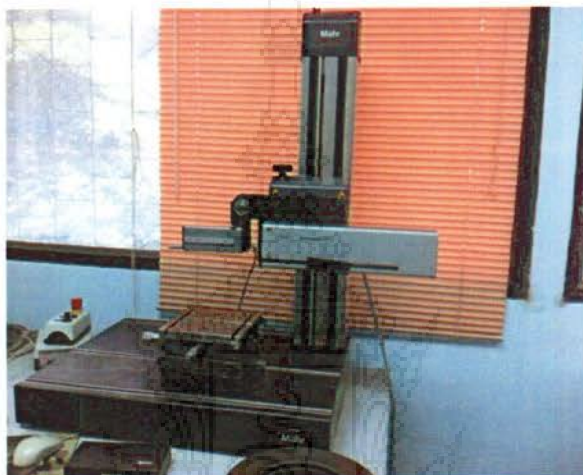
รูปที่ 3.7 เครื่องวัดความขรุขระ (Surface roughness)
