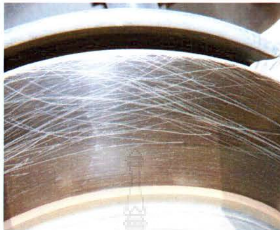
รูปที่ 2.3 การเกิดรอยบนจานเบรก ที่มา: http://www.caronline.net
