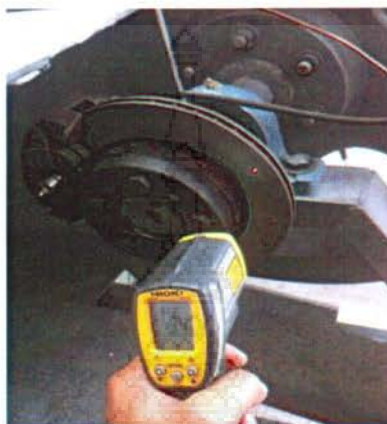
รูปที่ 3.13 วัดอุณหภูมิผิวของจานเบรก
