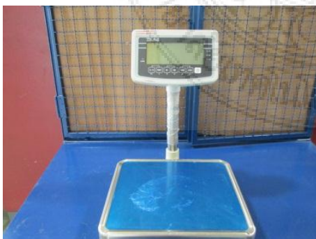
(ค) เครื่องชั่งน้ำหนักแบบดิจิตอล ยี่ห้อ TSCALE รุ่น VW-1
