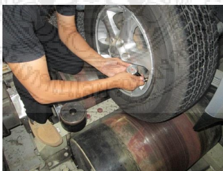
รูปที่ 3.10 วัดระดับความดันลมยาง
