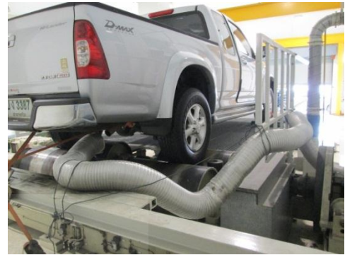
(ข) การติดตั้งท่อดูดไอเสีย
