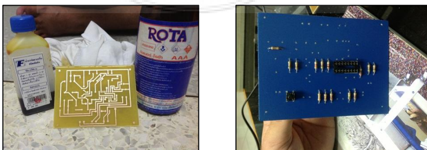
ภาพที่ 3.22 แผ่นปริ้นที่กัดลายวงจรแล้ว
