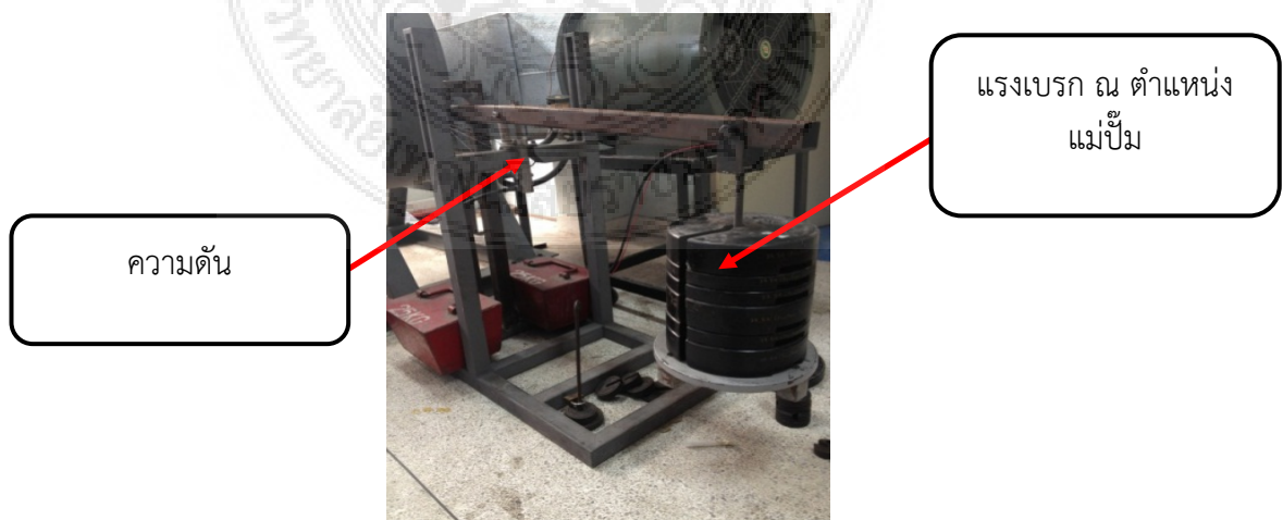
รูปที่ 4.5 การปล่อยตุ้มน้ำหนัก
