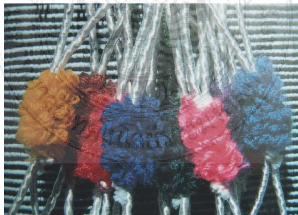
ภาพที่ ๒.๑๔ การรวมด้ายยืนมาไว้เป็นชุด ๆ แล้วนำมาพันและมัด โดยรอบไหมพรม
