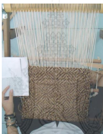
ภาพที่ ๒.๓๐ การทอลวดลายแบบทะแยงเส้นเดียว (ขึ้น ๓ ลง ๑) ๓/๑ และทอลายทะแยงสลั้ว (ขึ้น ๑ ลง ๓) ๑/๓
