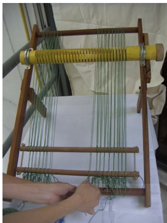
ภาพที่ ๒.๑๗ พาดเชือกขึ้นบนแกนไม้ล่าง
