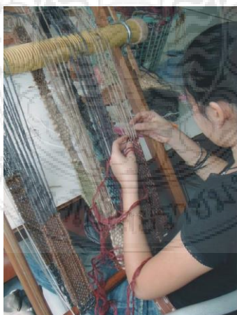
ภาพที่ ๒.๓๔ การทอแบบแยก ซึ่งการทอแบบนี้จะทอเป็นผลิตภัณฑ์ต่างๆ เช่น เข็มขัด สายสะพายกระเป๋า เป็นต้น
