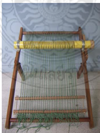
ภาพที่ ๒.๒๒ กี่ทอเมื่อขึ้นเส้นยืนครบทั้งหมดทุกร่อง (๖๒ ร่อง)
