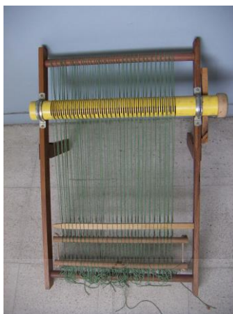
ภาพที่ ๒.๒๐ การขึ้นเส้นยืนที่สำเร็จเรียบร้อยพร้อมทั้งสำรวจว่าการพาดเชือกครบทุกตะกอโดยการนำเอาไม้แกะลายมาสอดตามภาพ
