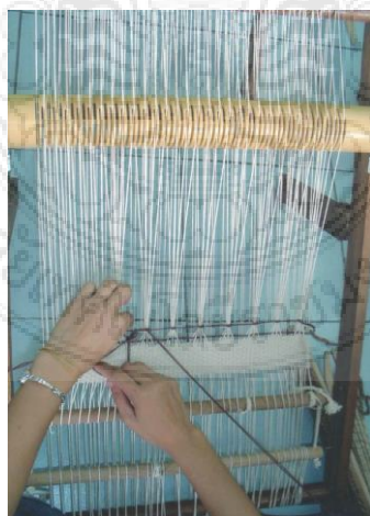
ภาพที่ ๒.๒๗ การทอชายผ้าหน้าประมาณ ๒ นิ้ว เพื่อเตรียมชิ้นการทอหลายลายต่าง ๆ
