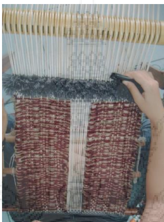
ภาพที่ ๒.๓๓ การทอด้วยการทำเฟอร์ (ขนปุกปุย) และทอเว้นช่องตรงกลางสำหรับตกแต่งด้วยวัสดุอื่นๆ
