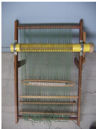
ภาพที่ ๒.๒๓ การทอโดยการนำกระสวยลอดใต้เส้นยืนจากขวาไปซ้าย
