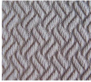
ภาพที่ ๒.๖๑ การทอลายขัดธรรมชาติ โดยใช้เข็มหรือไม้ถักด้ายยืนตรงบริเวณที่เพิ่มด้ายพุ่ง จะทำให้เนื้อผ้านูน
