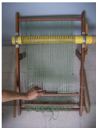
ภาพที่ ๒.๒๖ การใช้วิธีเส้นด้ายให้ตึงไม่ขาด (๑) ทอจนมีความกว้างประมาณ ๒ นิ้ว ก็สามารถทอตามแบบที่ต้องการได้
