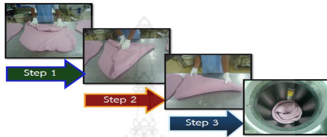
ภาพ 2.26 แสดงวิธีการใส่ขนมแผ่นแรกของการป้อนแบทพิตเตอร์แบบตั้ง
