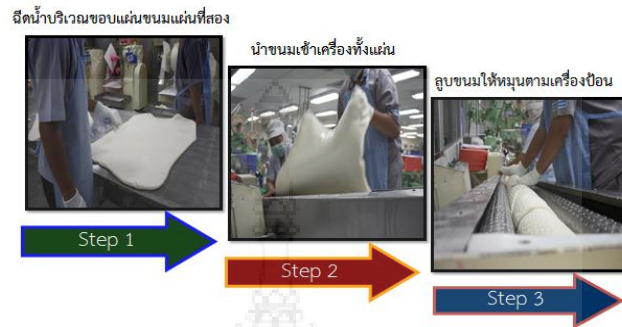
ภาพ 2.29 แสดงการป้อนขนมเข้าแบทฟิตเตอร์แบบนอน
