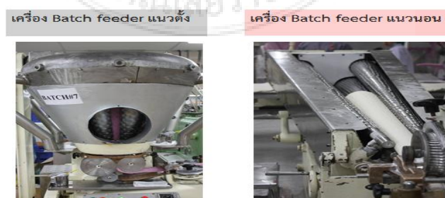
ภาพ 2.25 แสดงลักษณะแบบฟีดเดอร์แบบตั้งและแบบนอน
