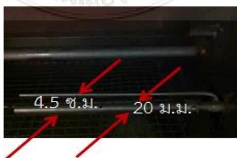
ภาพ 3.9 ขนาดแกนเหล็กที่ใช้ร้อยลูกกลิ้ง
