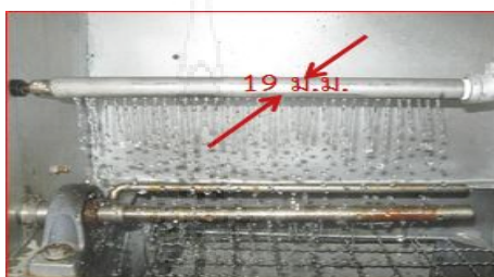
ภาพ 3.6 ท่อน้ำร้อนที่ใช้ฉีคล้างลูกกลิ้ง
