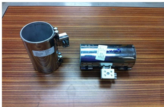
ภาพ 4.2 ฮีตเตอร์แบน ขนาด 220 โวลท์ 900 วัตต์, 800 วัตต์
