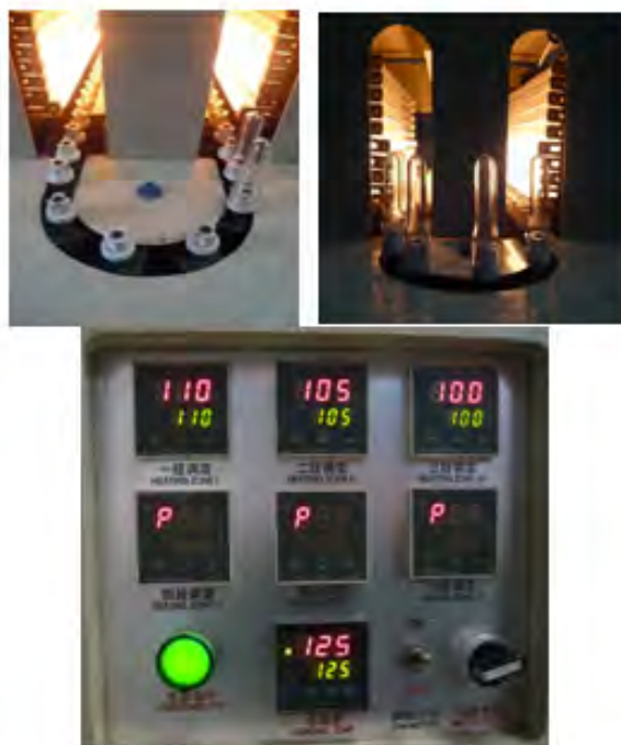
ภาพที่ 3-14 กระบวนการอุ่นพรีฟอร์ม(Preform)
