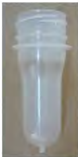
ภาพที่ 3-13 พรีฟอร์ม(Preform) ขนาด 15g
