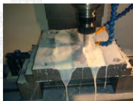
ภาพที่ 3-11 ขึ้นรูปแม่พิมพ์เป่าขวดพลาสติก
