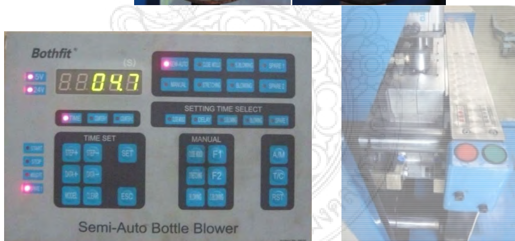
ภาพที่ 3-16 ความดันลมเป่าและเวลาที่ใช้เป่า
