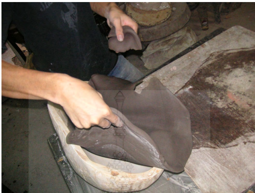
ภาพที่ 19 ภาพนำดินอัดในแม่พิมพ์
