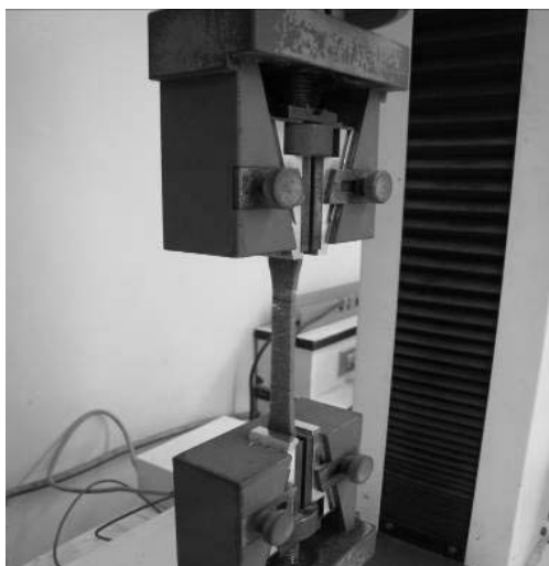
รูปที่ 3.3 เครื่องทดสอบความต้านทานแรงดึง
