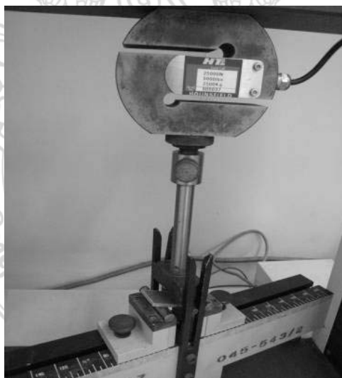
รูปที่ 3.4 เครื่องทดสอบต้านทานแรงคัด
